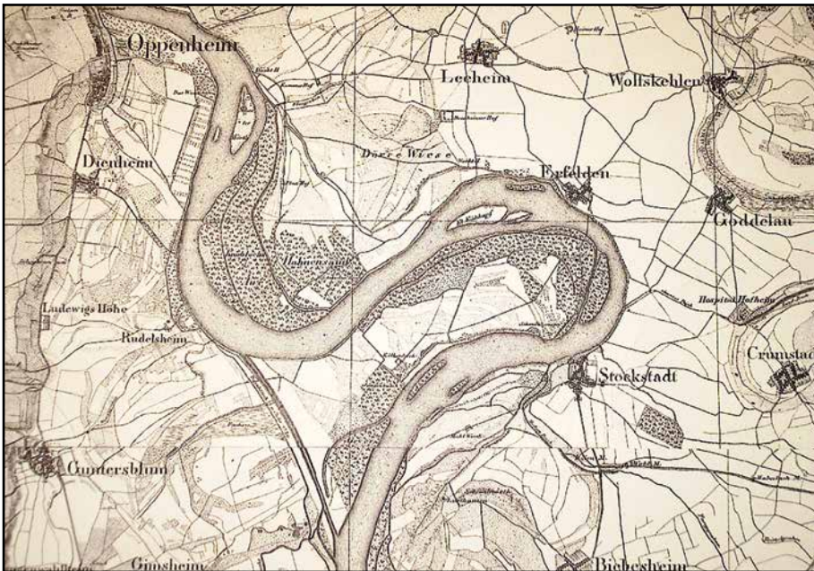
Abb. 1: Rheinverlauf im Bereich des Kühkopfs mit dem Durchstich der Rheinschleife bei der Rheinbegradigung. Vermessen im Jahr 1829 oder kurz danach (vgl. GROSS-HERZOGTUM HESSEN 1823–1850).
