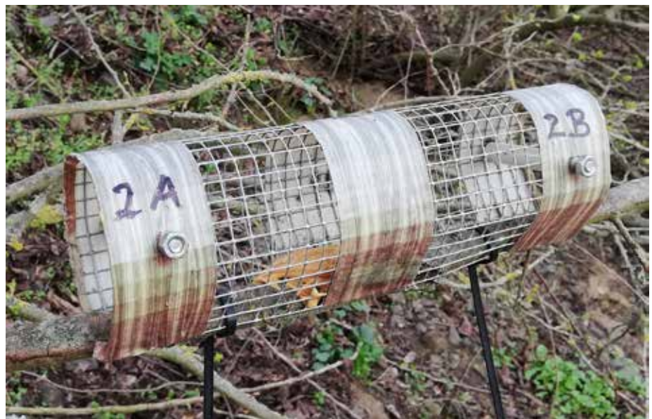
Abb. 1: Neue Haarfalle (Typ HF2R) aus grobmaschigem Draht. An beiden Öffnungen befindet sich ein Haarhafröhrchen mit doppelseitigem Klebeband; in der Mitte erfolgt die Beköderung mit z. B. Erdnussbutter. Die Haarfalle wird um den Ast installiert, um eine weitere Fortbewegung auf dem Ast zu gewährleisten. (Foto: inatu.re)
