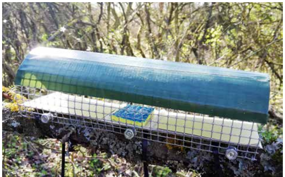
Abb. 2: Spurentunnel aus grobmaschigem Draht. Auf dem herausziehbaren Boden befindet sich zu beiden Seiten Löschpapier, in der Mitte das Farbkissen aus Schwammtuch und Fingermalfarbe. Die Installation erfolgt auf Ästen. (Foto: inatu.re)
